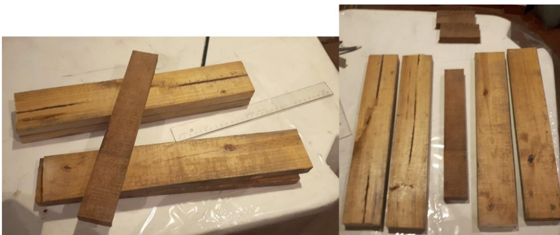
Cortes e medidas para montagem do 'super sargento'.
