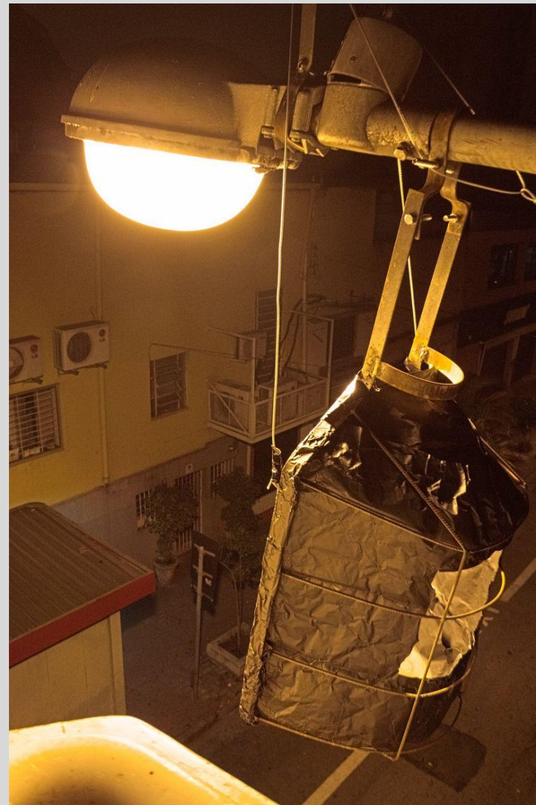
Traquitana do tipo “dimmer” ou recorte de luz.
