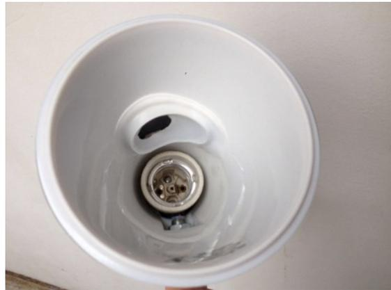
Figura 4: Ao ligar uma lâmpada de 100W em um abajur cujo limite era de 15W, presenciou-se o derretimento de parte da cúpula. Fotos por Gabriel Barone, 27 de abril de 2016.
